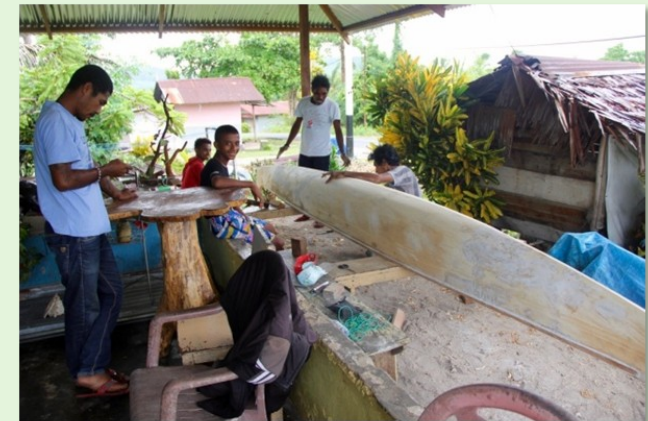
Een ‘prauw’ in aanbouw: de buitenkant wordt gereed gemaakt.
